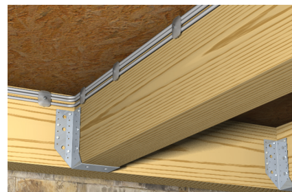
Flere kabler på træ
